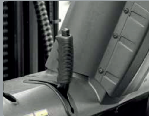
Freio de Estacionamento O freio de estacionamento com catraca requer menos esforço do operador para ajuste.
