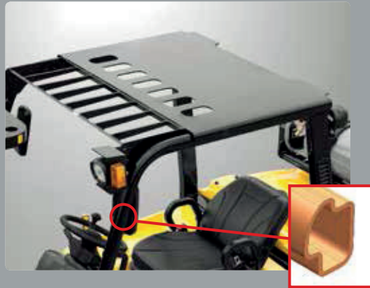
Forte proteção da cabine de operação A proteção da cabine cumpre a norma ISO 6055 e protege o operador durante trabalhos perigosos.
