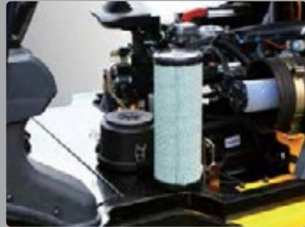
**Substituição fácil de filtro de ar**
