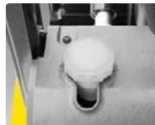
**Reservatório de fluido de freio com interruptor de nível**
